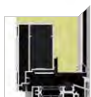
Detail Bodenschwelle (S30)
